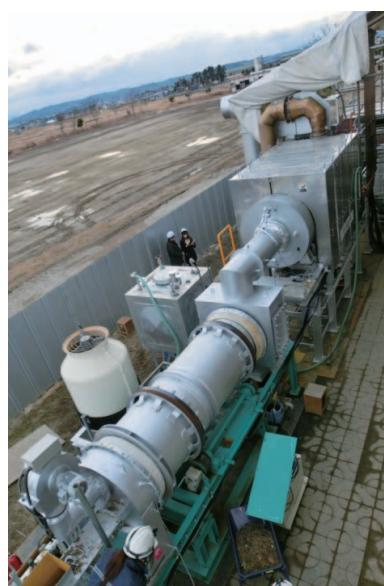
図4 マイクロ波迅速アスベスト含有廃棄物連続処理装置
